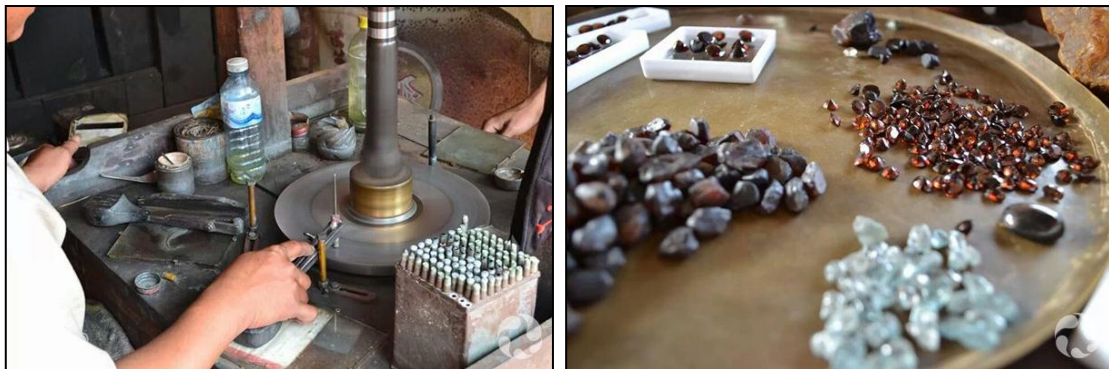
รูปที่ 6.1 การเจียรไนพลอยจากเซอร์คอน และสีของพลอยหลังจากการเผา
